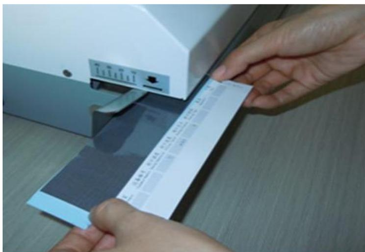
图18封口测试卡（纸）
